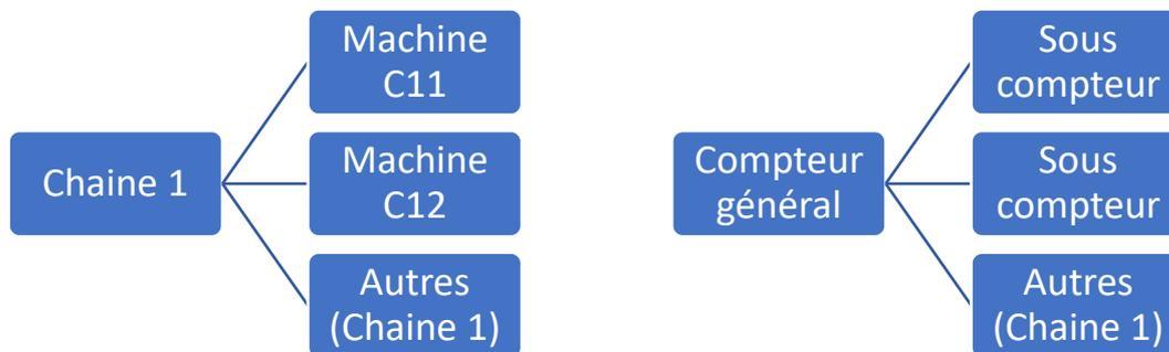
Dans cet exemple, le compteur « Chaîne 1 » est le compteur général, et le compteur Machine C11 et Machine C12 sont des sous-compteurs. Effectivement, le compteur général comprend la consommation du compteur machine C11, du compteur machine C12 et des autres consommations de la chaîne 1 qui ne sont pas suivies.
